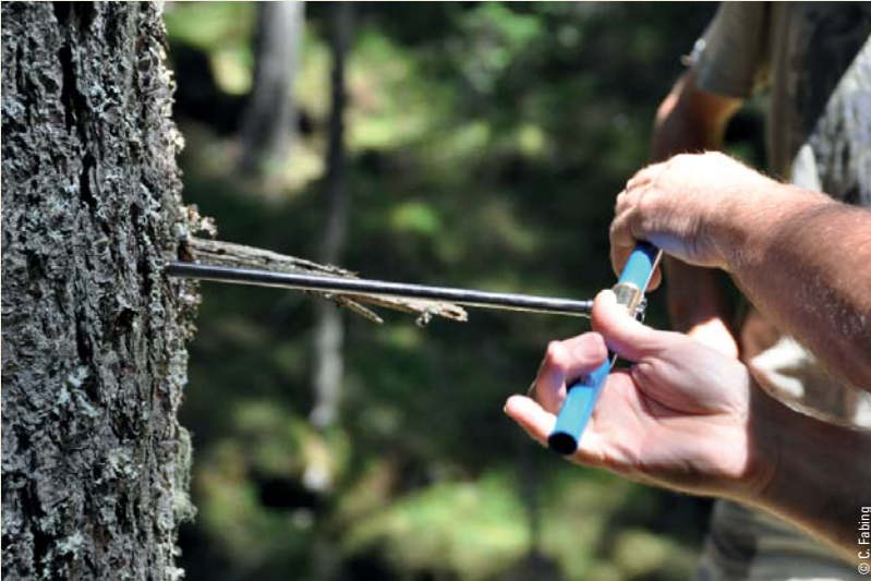
Carottage d'un arbre à l'aide d'une tarière de Pressler
